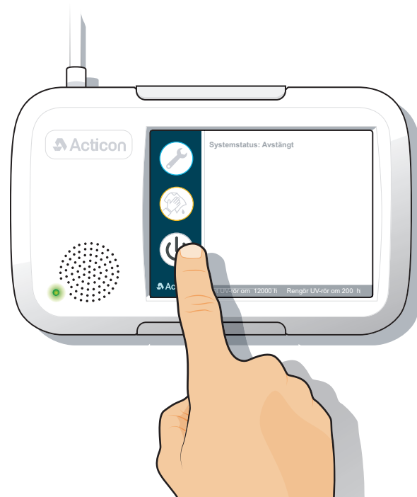
Figur 3 - Tryk på "on/off-knappen" for at starte eller stoppe systemet.
