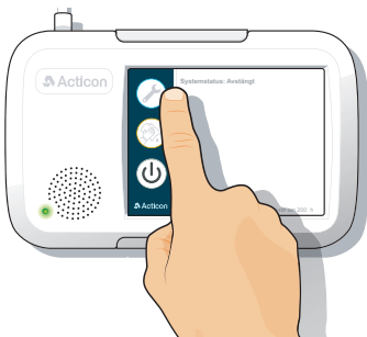
Figur 12 - Efter lampeskift trykkes der på "servicemenu"
