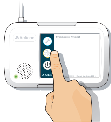
Figur 8 - Efter rengøring trykkes der på vedligeholdelsesmenuen.
