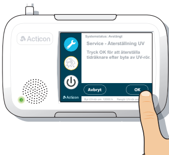
Figur 12 - Efter lampeskift trykkes der på "servicemenu"
