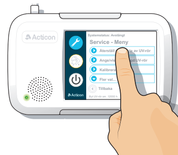
Figur 14 - Tryk på "Nulstil efter skift af UV-rør".
